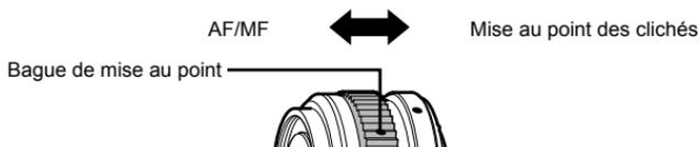
Avec la mise au point des clichés, une distance est définie à l'aide de la bague de mise au point en fonction de la distance de la prise de vue. L'appareil photo effectue la mise au point sur une profondeur de champ qui correspond à la valeur d'ouverture définie.
